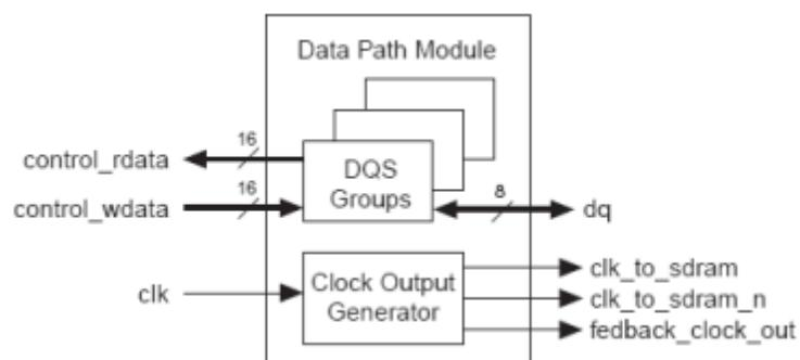
图2.1 数据通道模块内部结构
